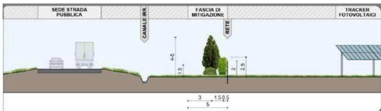
Schema d'impianto in sezione fascia di mitigazione Sez. D'-D''
