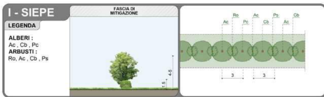
Individuazione e Schema d'impianto in sezione fascia di mitigazione Sez. I'-I''
