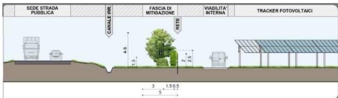
Schema d'impianto in sezione fascia di mitigazione Sez. F'-F''
