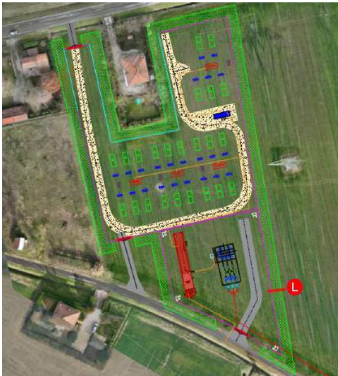
Sistema di accumulo e Sottostazione elettrica utente, con indicato in verde la fascia di mitigazione.
